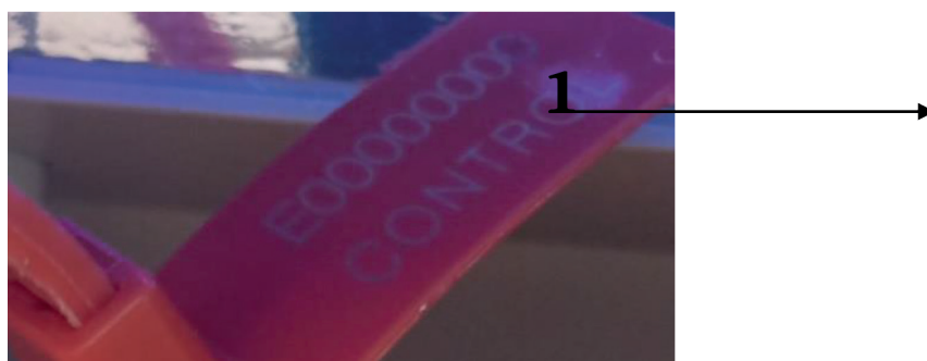
Изображение 8. Общий вид люминесценции следов на контрольном номере, где 1 -люминесценция динамических следов на поверхности пломбы в УФ-лучах 365 нм
