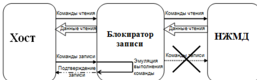
Рис.1. Общий принцип работы аппаратных блокираторов записи
