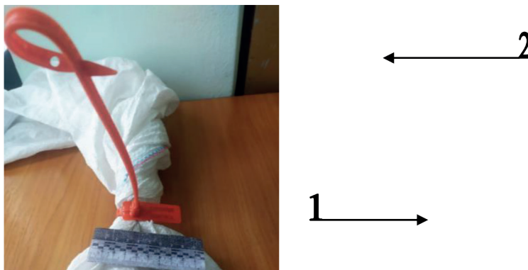
Изображение 5. Общий вид установленной пломбы, где 1 - гибкий элемент, установленный вокруг горловины мешка, 2 - конец гибкого элемента, завернутого в петлю
